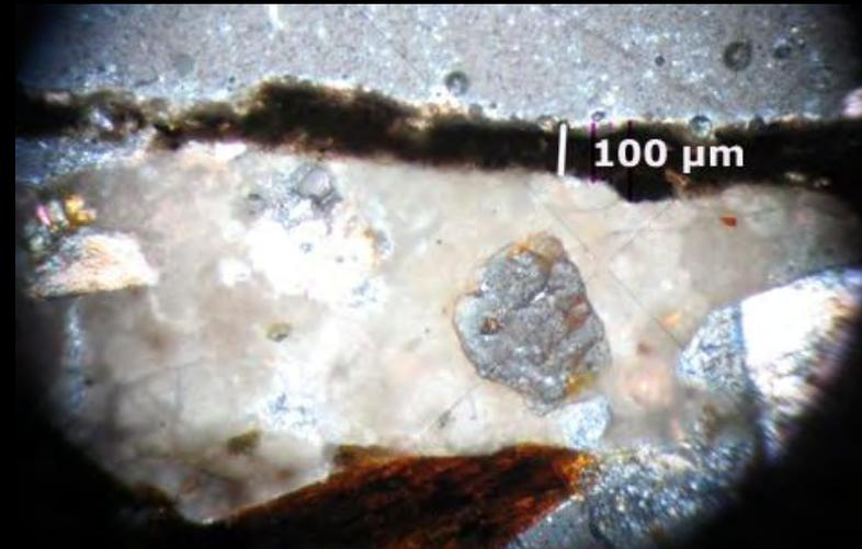
Sezione sottile della finitura dell'intonaco della cappella 13 con indicazione del relativo spessore
