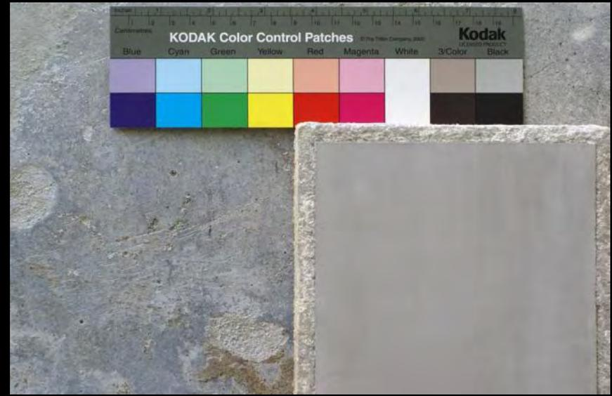
Campione di intonaco prodotto in laboratorio accostato all'intonaco in opera sul lato nord della cappella 25 (presso il punto di prelievo dei campioni analizzati).
