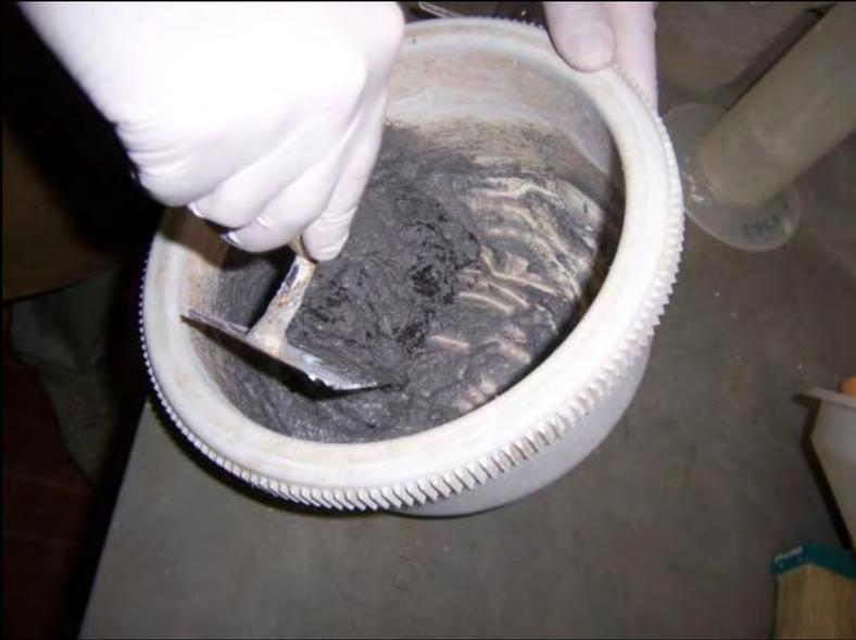
Sull'intonaco dello strato di corpo in fase di carbonatazione sono state stese diverse miscele di finitura, con uno spessore variabile tra 100 e 200  $\mu\text{m}$  circa
