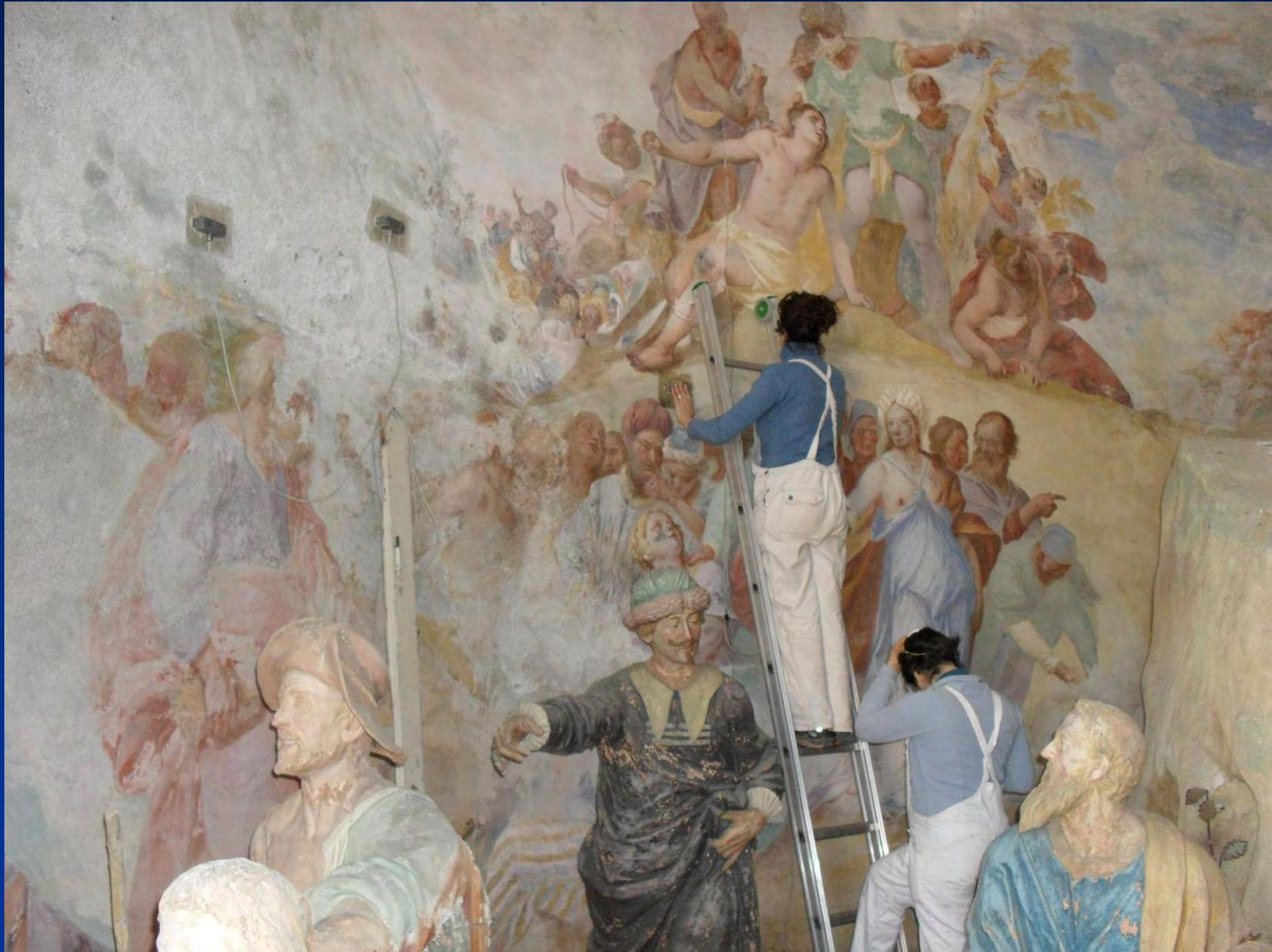
**I sensori sono stati applicati in zone utili a monitorare contemporaneamente sia l'avanzamento della lesione che il distacco dell'intonaco.**
