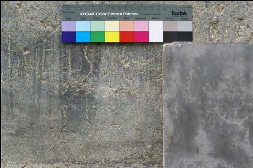
Campione di intonaco prodotto in laboratorio accostato all'intonaco in opera sul lato est della cappella 13 (sotto la striscia di riferimento cromatico è visibile una data incisa: 1508).
